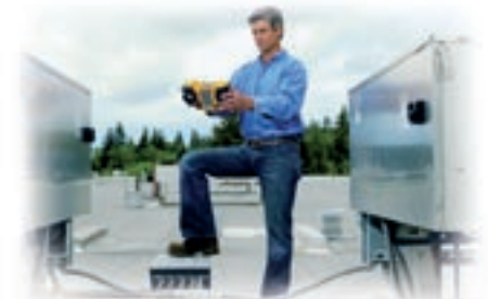
IR-Kameras lokalisieren Wärmebrücken, Leitungen, Leckagen oder Problembereiche an elektrischen oder (haus-)technischen Anlagen (Fluke)
