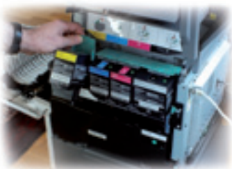
Der Lexmark hat vier separat wechselbare Tonerkassetten.
