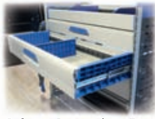
Lieferwagen Inneneinrichtung: Ein Faserverbundwerkstoff erlaubt die Produktion von großen, säurefesten, robusten Wannen und Schubladen.
