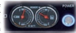
Auf der Kamera gibt es zwei kleine Analog-Anzeigen für Akku-Ladezustand und freie Speicherkapazität.
