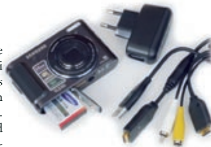
Der Lithium-Ionen-Akku hat 1130 mAh bei 3,8 Volt. Zum Lieferumfang gehört auch ein USB-Netzteil, ein USB-Datenkabel und ein Video-Kabel.
