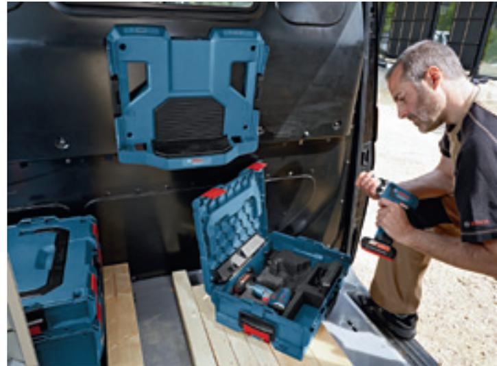
Das „Wireless Charging System“ von Bosch bekommt kompakten und gleichzeitig leistungsfähigen Zuwachs in der 10,8 Volt-Klasse: den 2,5 Ah-Akku GBA 10,8V 2,5 AH OW-B Professional. Handwerker können die Vorteile des induktiven Ladens damit erstmals in der 10,8 Volt-Klasse nutzen. Wie bei den 18 Volt-Geräten laden die Werkzeuge bei jedem Kontakt mit dem „Wireless Charging“-
