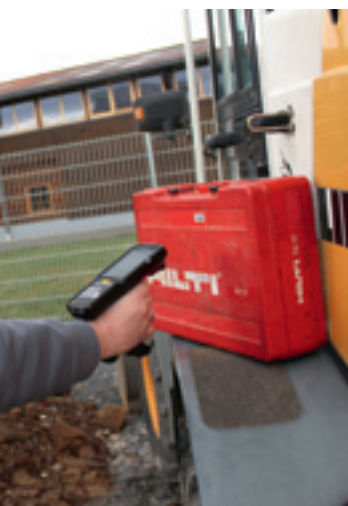
Bild unten: Materialien und Maschinen lassen sich digital mittels Barcode direkt erfassen. Das ermöglicht eine zeitnahe Datenpräsenz im gesamten Unternehmen.
