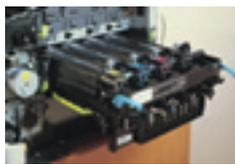
*Für Wartungsarbeiten klappt man zunächst die Abdeckung nach oben und die Front nach unten und kann danach sehr einfach die Tonerkassetten tauschen. Wenn alle Tonerkassetten und der Resttonerbehälter herausgenommen wurden, lässt sich das Imaging-Kit aus Fotoleiter und Entwicklereinheiten herausziehen und tauschen.*
