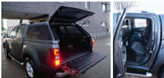
*Ganz links: Das Hardtop mit geöffneten Klappen (unten Metall und oben Glas!)
