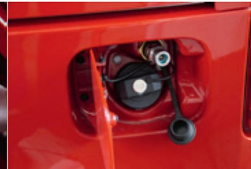
Einfüllstutzen für Superbenzin unten und für das komprimierte CNG-Erdgas oben.
