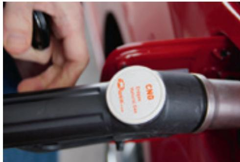
Die CNG-Zapfpistole, die sich mit dem Autoanschluss verriegelt, bevor das CNG in den Tank fließen kann.
