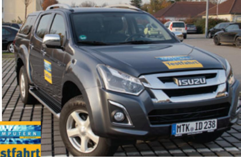
Unser Testfahrt-D-Max kann wahlweise als Heckantriebler oder als allradgetriebenes Fahrzeug bewegt werden; zum Umstellen genügt das Berätigen des Drehschalters. Die 120 kW (163 PS) bei 3.600 U/min Leistung erlauben eine Höchstgeschwindigkeit von 180 km/h. Der seit Mai 2017 eingebaute 1,9 Liter Dieselmotor erfüllt die Euro 6-Norm ohne AdBlue, die Leistungen sind ansprechend: Souverän bewegt er bis zu 1.225 kg Zuladung und 3,5 t Anhängelast (bei allen 4WD-Modellen) über Stock und Stein.
