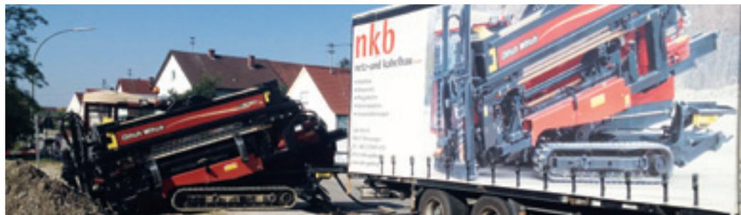
Mit Hilfe dieser Spülbohranlage wurden die Leerrohre für die Glasfaserkabel durch die Firma mecom zu 90% innerorts grabenlos verlegt
