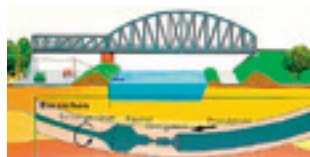
Mit Hilfe des Spülbohrverfahrens fallen große Teile der Grabungsarbeiten für die Glasfaserverlegung weg. Bild: RWE
