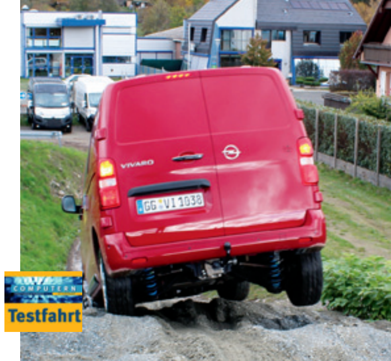
Auch wenn nur noch drei Räder am Boden sind, dreht der Opel Vivaro 4x4 nicht durch, dank Visco-Kupplung. (Bilder: Sanders)
