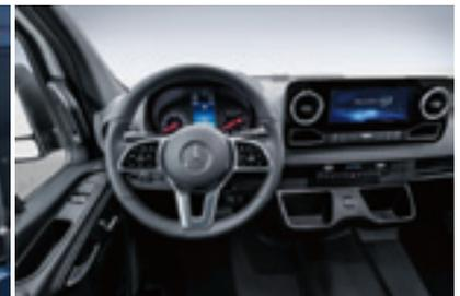
Das Multifunktionslenkrad des Sprinters aus einer früheren Präsentation
