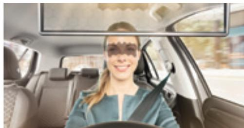
Mit dem Virtual Visor ersetzt Bosch die klassische Sonnenblende im Auto durch ein transparentes LCD-Display. Foto: Bosch
