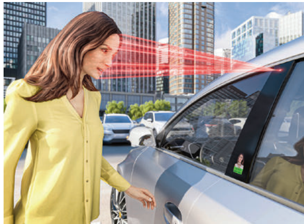
Continental hat mit „Face Authentication Display“ eine biometrische Entsperrung von Autos präsentiert. Sowohl in der B-Säule, als auch hinter dem Fahrerdisplay gibt es Kameras für die Gesichtserkennung. © Continental
