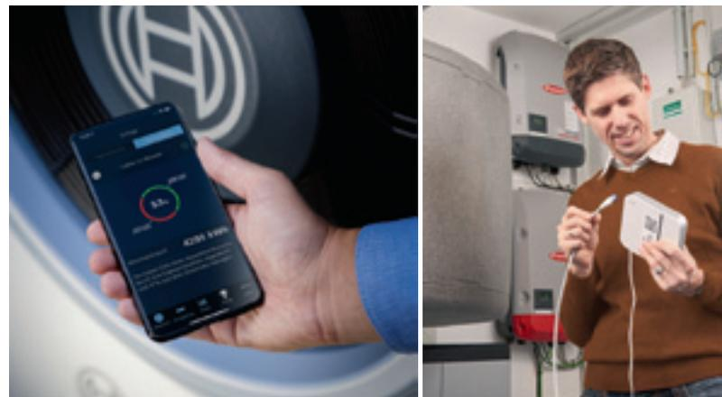
Per App sieht man die Einspar-Erfolge durch den Einsatz des Energiemanagers von Bosch. Hier die Ansicht des Anteils des selbst produzierten Stroms.
