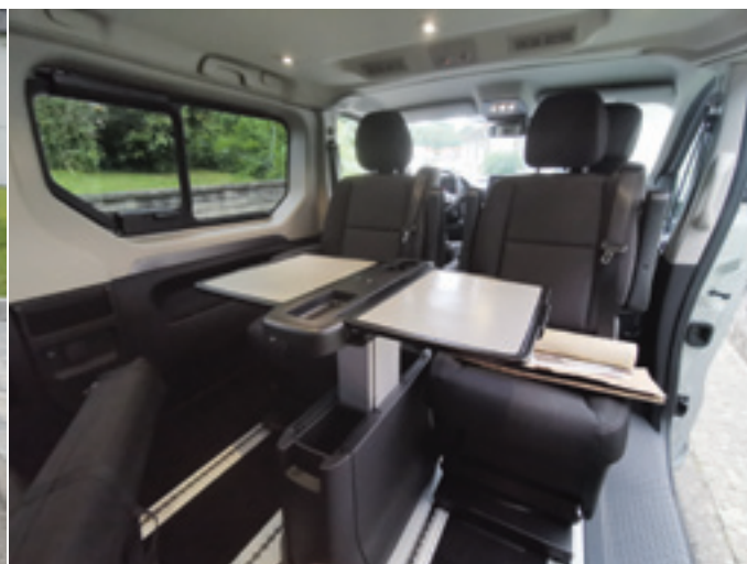
Ein verschiebbares Modul mit Stauraum und ausklappbarem Tisch gehörte zur Bestattung dazu. Die beiden Sitze der zweiten Reihe sind drehbar.
