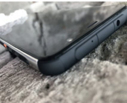
Das Gehäuse des RG850 ist aus einer speziellen Polycarbonat-Mischung gefertigt, bei der Crash-Zonen die Aufprallenergie bei Stürzen auffangen.
