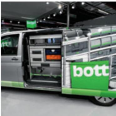
*VW-Transporter T6 mit Bott-Einbauten*
