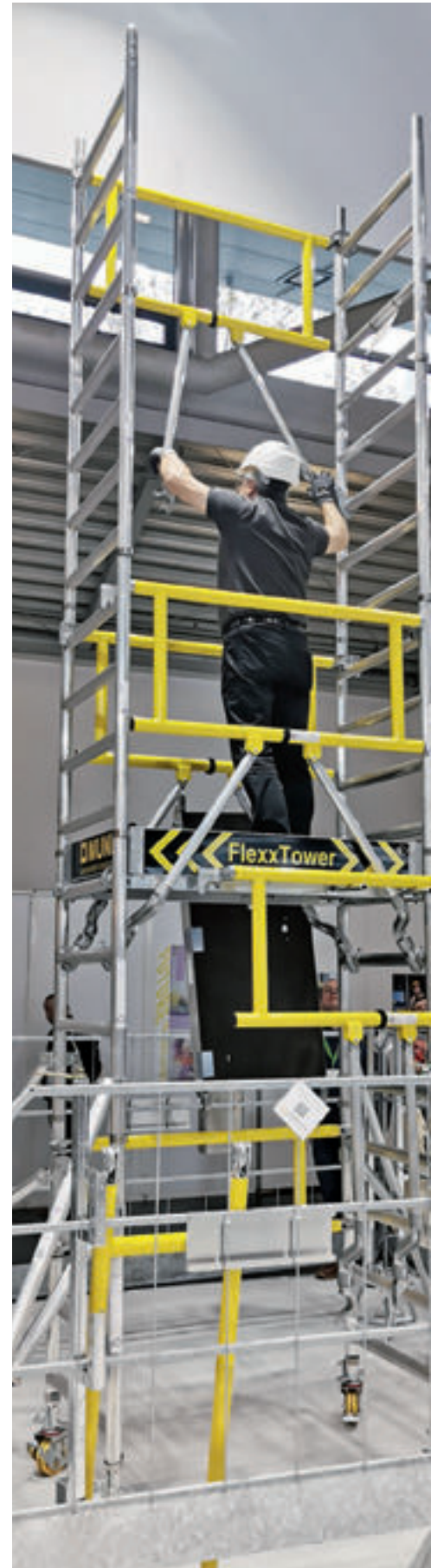
Das Ein-Personen-Gerüst von Munk am Stand der BG Bau. (Alle Fotos: Sanders)
