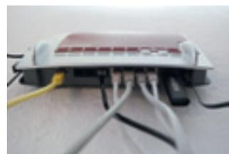
Die Anschlüsse von links nach rechts: seitlich 2 TAE-Buchsen für Telefon/Fax, DSL/IP-Telefonie-Anschluß, 2 RJ11-Buchsen (parallel zu den TAE-Buchsen), RJ45-Buchse für ISDN-S0-Telefon/Bus, 4 Gigabit-Ethernet-Buchsen, USB-3.0-Buchse (aktuell mit Stick für Musik im ganzen Haus bestückt), Stromversorgung des Steckernetzteils, seitlich eine weitere USB-3.0-Buchse.
