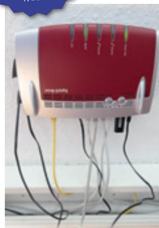
Noch ist die Verkabelung im Homeoffice nicht abgeschlossen und der Kabelkanal unter der FRITZ!Box 7490 nicht abgedeckt, aber die Kommunikation erfolgt bereits reibungslos. Ein kleiner Schönheitsfehler ist, daß die Beschriftung der Fritz!Box bei Wandmontage auf dem Kopf steht. (Fotos: Peter Pernsteiner)
