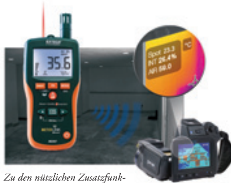
Zu den nützlichen Zusatzfunktionen gehört die Funkübertragung von Messwerten, hier eines Feuchtefühlers, ... (FLIR Systems)
