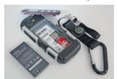
Nach herausnehmen des Akkus findet man die Halterung für die SIM-Telefonkarte und daneben eine Klapphalterung für eine microSD-Speicherkarte mit bis zu 32 GB
