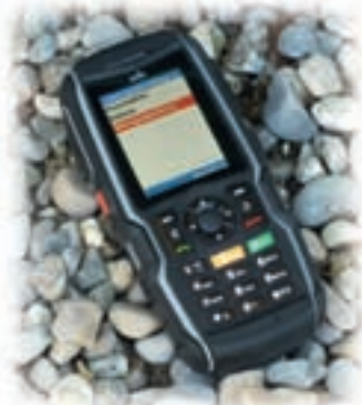
Das Alleinarbeiter-Handy kann in zwei PNA-Modi betrieben werden – einfach mit Alarmierung per Knopfdruck oder im Bewegungssensor-Modus mit Totmannschaltung.
