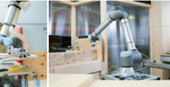
Von links nach rechts: Der Cobot gleitet auf Schienen. Ein UR10e hebt Holzteile. Präzise und behutsam werden die Holzteile aufgenommen. Der Autor am UR10e.
