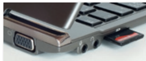
Rechts hinten findet man den SD-Kartenslot und die Mikrofon- und Kopfhörerbuchsen. An der Rückseite folgen dann die Buchsen für VGA-Monitor, Netzteil, HDMI und zweimal USB 2.0.
